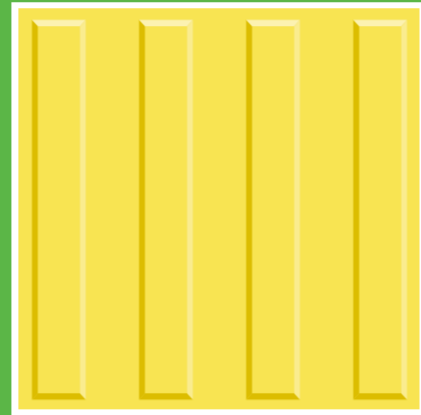
誘導ブロック
